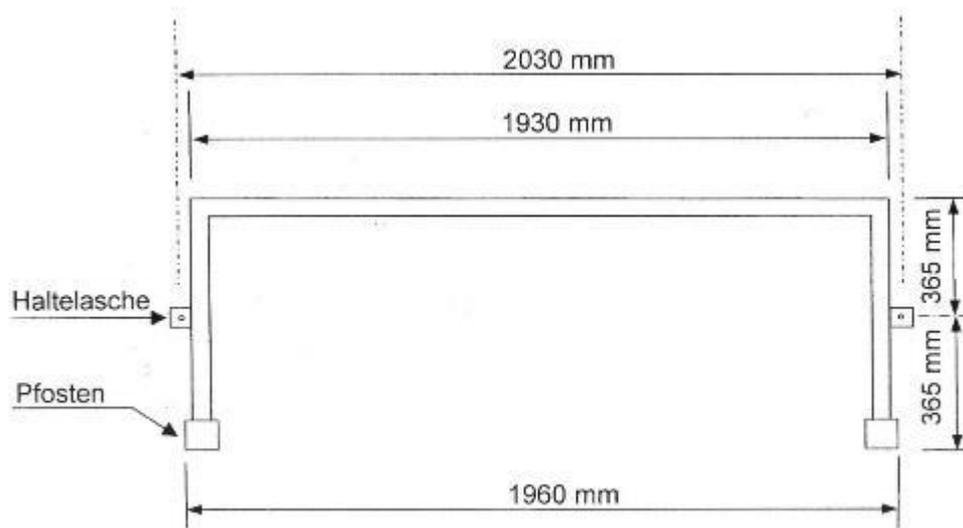
d) **Draufsicht Bodenverankerung Mini-Bolzplatztor 2,40 x 1,60m:**
