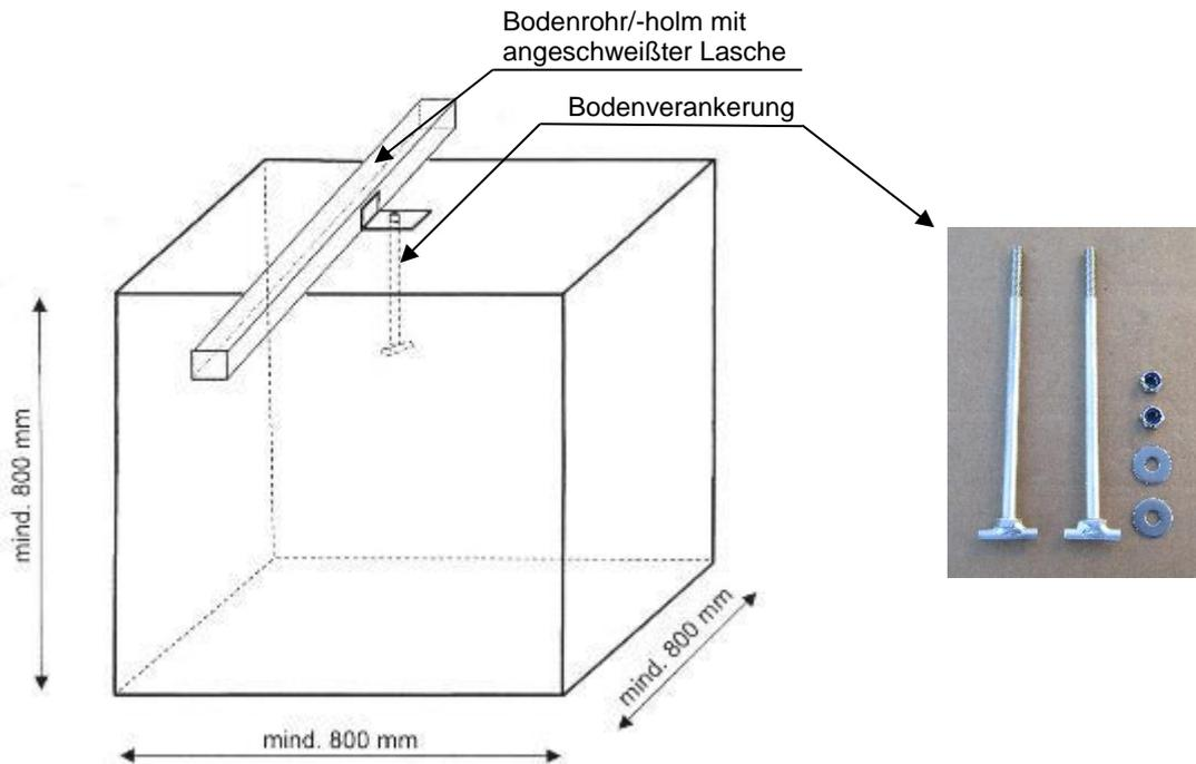
**b) Draufsicht Bodenverankerung Mini-Bolzplatztor 1,20 x 0,80m:**
