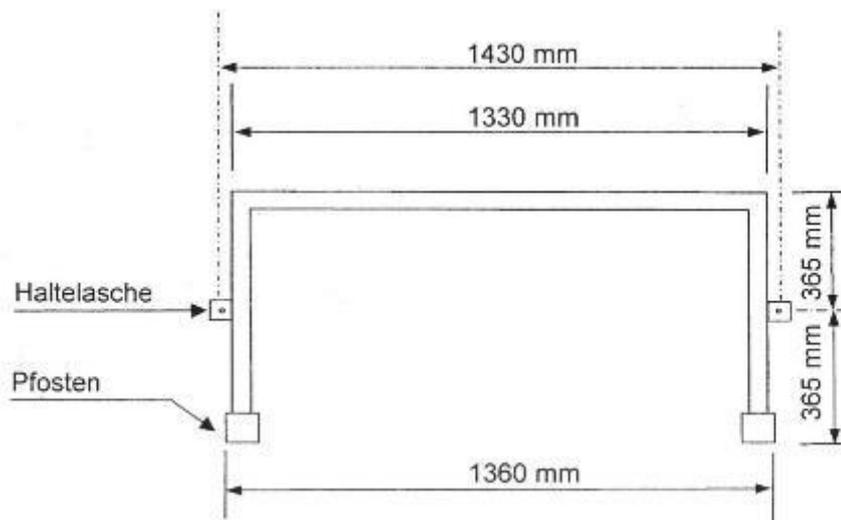
c) **Draufsicht Bodenverankerung Mini-Bolzplatztor 1,80 x 1,20m:**
