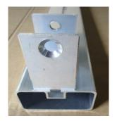
d) Pfostenverschlusskappe 80 x 40 mm in Pfosten einschlagen (dafür ggf. einen Gummihammer benutzen), anschließend unteres Scharnier ausrichten und Befestigungsschraube fest anziehen. Dabei beachten, dass das Scharnier unten bündig mit der Pfostenverschlusskappe abschließen muss.
