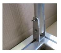
i) Gewinderingösen M 6 x 50 durch die Bohrungen des Netzbügels stecken (Position siehe Foto unten) und mit Unterlegscheibe DIN 9021, 7,4 x 22 und selbstsichernder Hutmutter DIN 986, M 6 befestigen.
